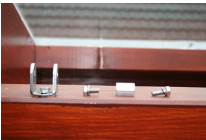
7) Aufbau einer Konsole. Die kurze Schraube (12mm) ist zum Fixieren des Sechskants, die längere (16mm) zum Klemmen des Drahtes.
